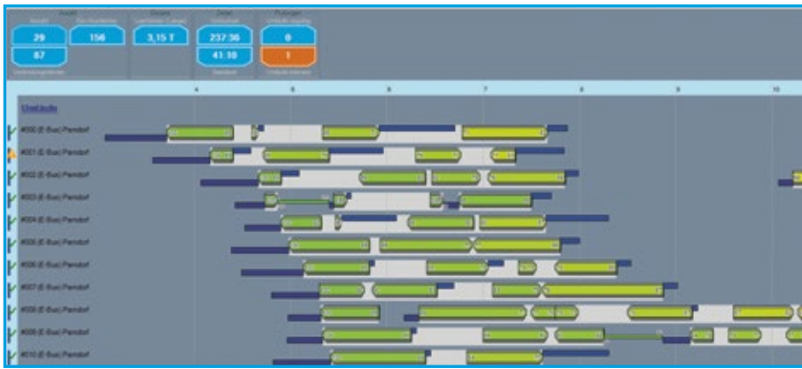
Abb. 6 Umlaufbildung im Nordburgenland: Schnell zeigte sich, dass nur mit stärkeren Batterien und gelegentlichem Zwischenladen ein sinnvolles Befahren möglich ist. Die Fahrzeuge müssen eine Reichweite von 300–350 km erreichen, um den vorgegebenen Fahrplan mit möglichst wenigen Fahrzeugen zu befahren.
