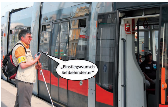
BILD 5: Kommunikation zwischen Fahrzeug und Smartphone – Einstiegswunsch
